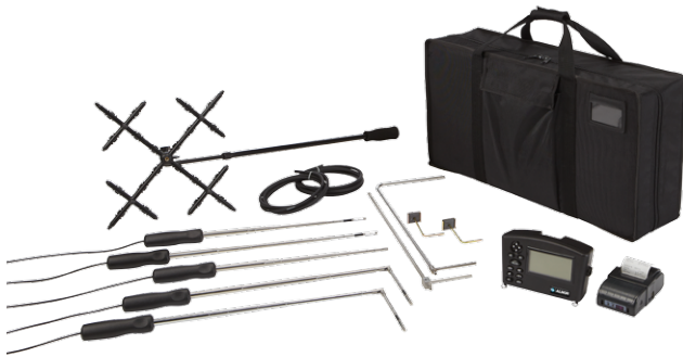
Modell 8715 (Mikromanometer mit Standard- und optionalem Zubehör)
