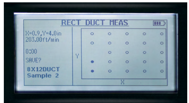
Integrierte Kanalmessanwendung (Kanaltraverse)
